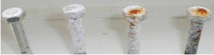
EP亜鉛+六価クロム化成処理+下地塗装
