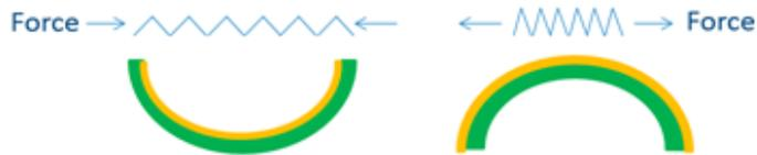
引張り(左)と圧縮(右)応力。析出された銅はスプリングの様におもわれます。そのスプリングは引張応力による張力(延伸)または圧縮応力による収縮のいずれかです。
